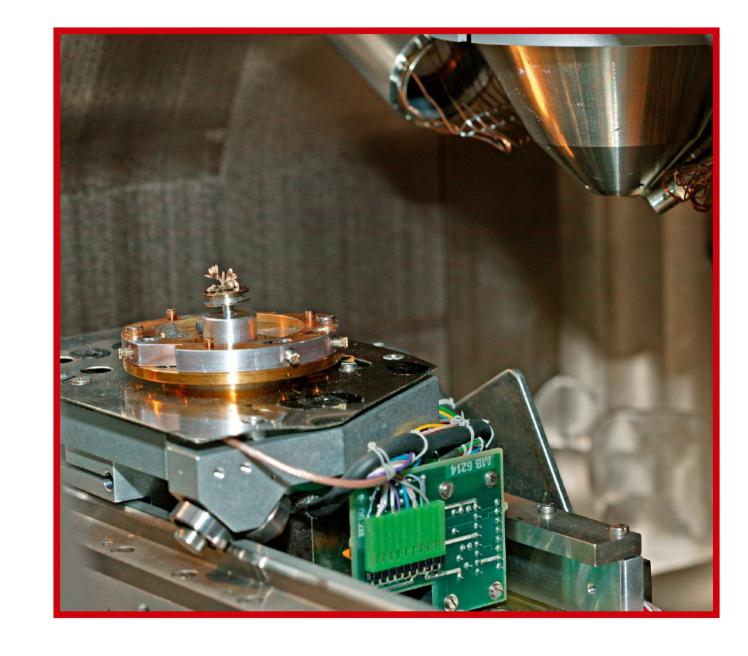
Das Präparat ist nun auf dem kipp-, dreh- und X-Y-Z verschiebbaren Objekttisch befestigt. Im Hintergrund sichtbar links ein SE-Detektor, die konische Endlinse des Elektronenmikroskops und ein kleiner BSE-Detektor.
