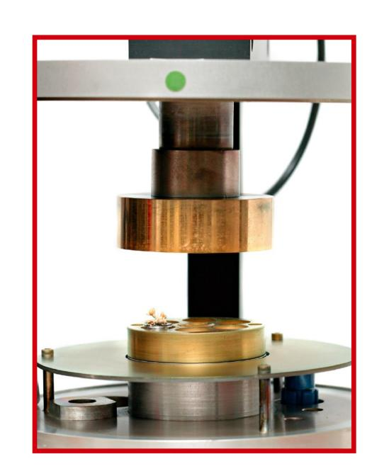
So sieht es im normalerweise geschlossenen Glasgefäß aus: das Präparat liegt unten, darüber das von einem Ringmagnet umgebene Edelmetall-Target (in diesem Fall Gold).
