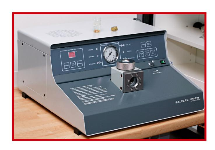
In diesem "Kritisch-Punkt-Trockner" wird der Alkohol gegen flüssige Kohlensäure ausgetauscht, bei einem Druck von ca. 50 bar.
