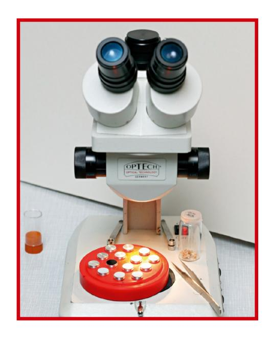
Unter einem Stereomikroskop wird das trockene und sehr zerbrechliche Präparat schnellstmöglich (es ist ja sehr hygroskopisch) in der gewünschten Orientierung auf einen Objektträger geklebt.
