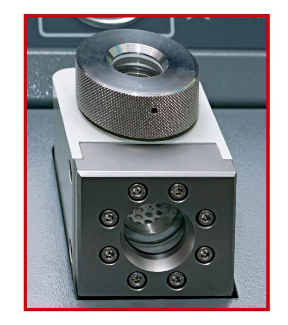
Die flüssige Kohlensäure wird erhitzt und erreicht bei 31°C und 73,8 bar ihren "kritischen Punkt", sie geht vom flüssigen Zustand ohne Phasengrenze in den gasförmigen über. Dadurch wird der Strukturerhalt gesichert. Das Gas wird langsam abgelassen.
