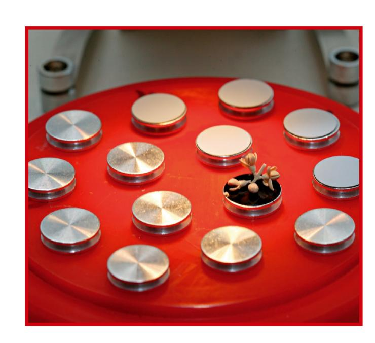
Hier sieht man die 12mm durchmessenden Aluminium-Objektträger.
