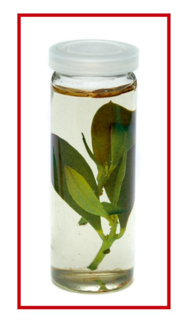
Die Probe wird zuerst in einer Glutaraldehyd-Lösung fixiert. Dies dient dem Struckturerhalt. Dann beginnt eine Entwässerungsreihe mit steigenden Prozentzahlen Wasser / Alkohol.
