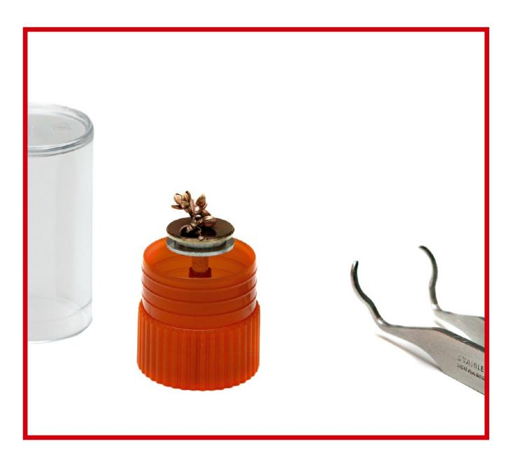
Nach 3 bis 5 Minuten "sputtern" kann das Präparat entnommen werden. Es ist sehr feuchtigkeitsempfindlich und wird, falls es nicht sofort ins Mikroskop kommt, in einem kleinen luftdichten Behälter aufbewahrt.
